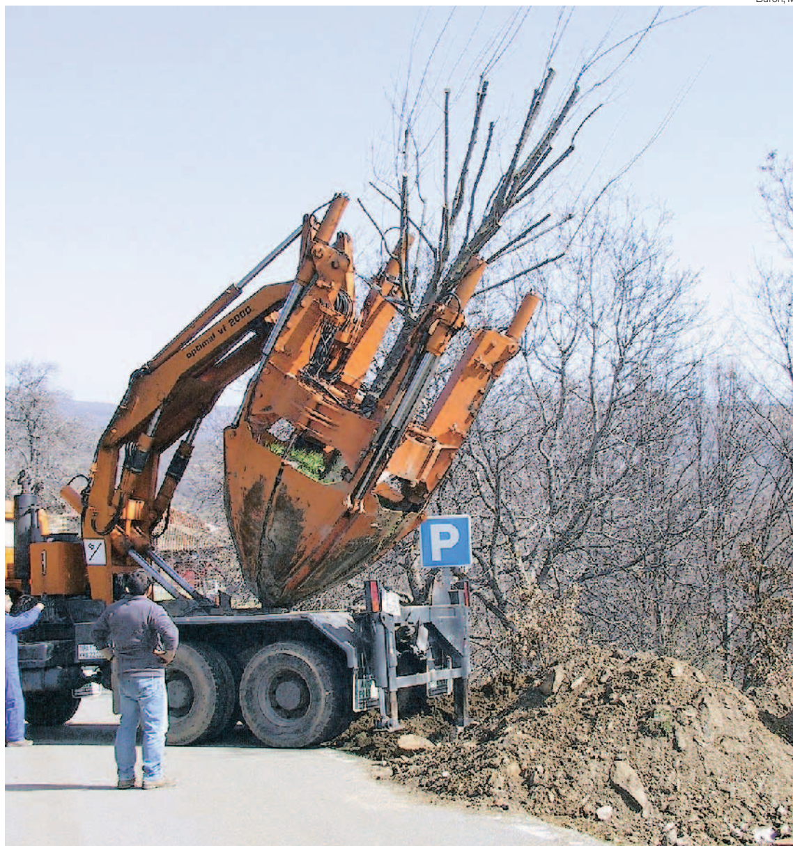
LA MAQUINARIA utilizada para los trasplantes permite cepellones de 2 metros de diámetro por 1,2 de profundidad, el equivalente a un contenedor de basura
